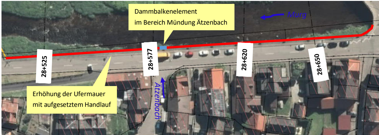
Abbildung 5.4 Lageplan Maßnahmen M3, Bereich Obertsroter Str.
