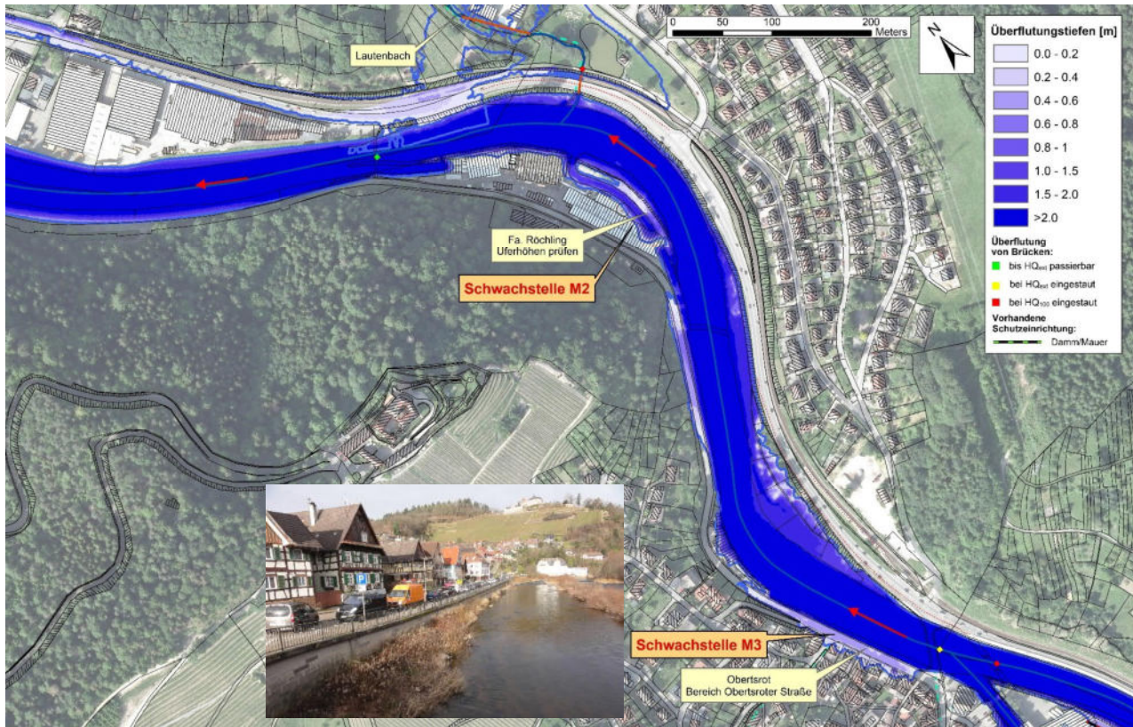
Abbildung 3.3 Übersicht Schwachstellen an der Murg in Gernsbach, Bereich Obertsrot
