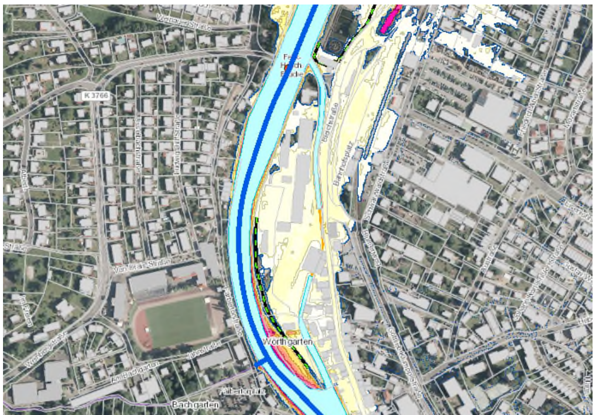
Bild 12: Hochwassergefahrenkarte mit Darstellung der Überflutungstiefen bei HQ 100
